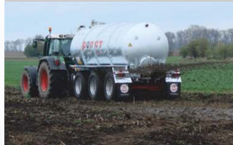
ŁYŻKA ROZLEWAJĄCA szerokość robocza od 8 do 12 m
