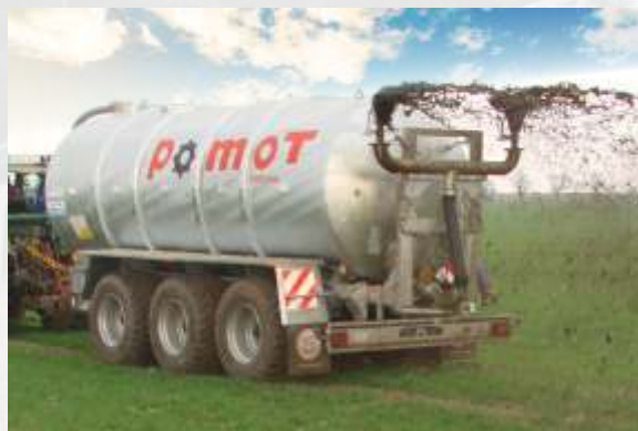
ROZLEWACZ DUPLEX szerokość robocza od 16 do 18 m
